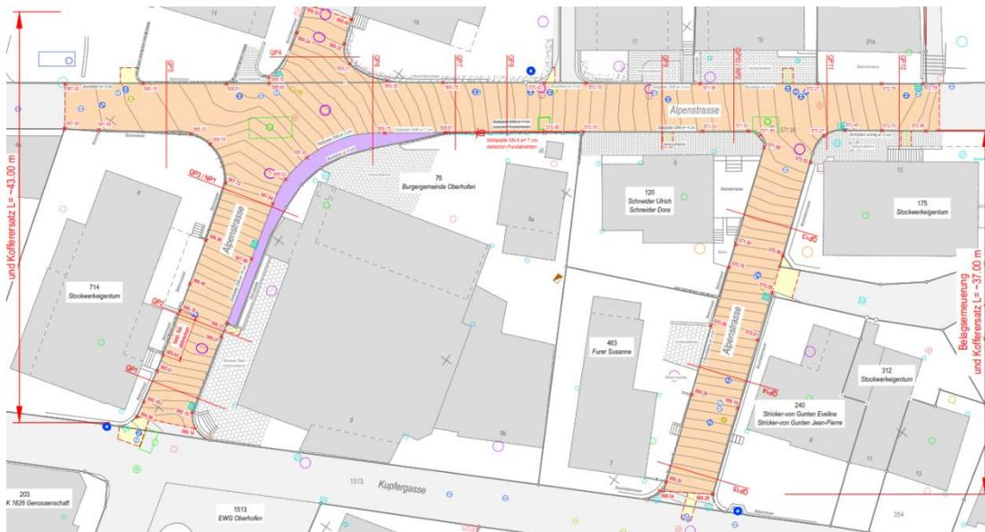
Die in orange markierte Fläche zeigt den Perimeter des Projekts und grenzt den Bereich ab, in welchem die geplanten Arbeiten erfolgen.
